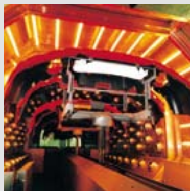
Härten von Lack auf Stoßdämpfern
