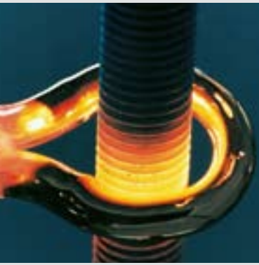
Kunststoff erwärmen mit einem Omega-Strahler
