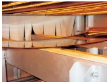
Erwärmen der Ränder von Autoscheiben zur besseren Haftung von PU Schaum
